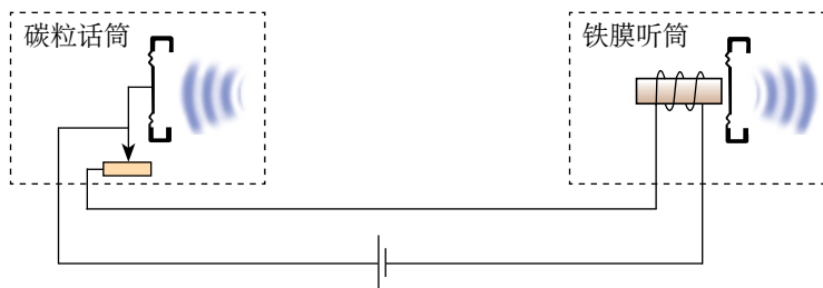
图17-1-10 老式电话机的原理图
