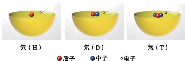
图1-1-3 氕、氘、氚原子中质子、中子和电子的数量关系示意图
