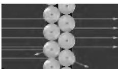
实验结果：绝大多数 \alpha 粒子通过，少数 \alpha 粒子偏转，个别 \alpha 粒子被反弹
