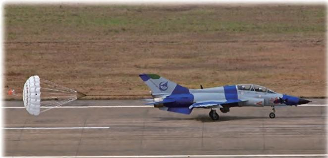
图 1-4 飞机着陆后打开尾部减速伞
